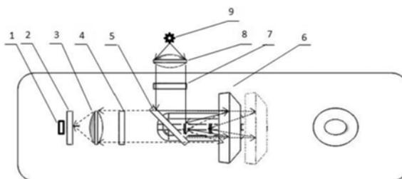
1. 一种单色荧光检测装置,其特征在于:包括光电探测器(1)、小孔光阑(2)、聚焦透镜(3)、第一滤光片(4)、二色镜(5)、抛物面反射镜(6)、第二滤光片(7)、准直透镜(8)和LED光源(9);
