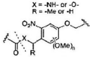
基于邻硝基苄基的链接基， 在300-365 nm 裂解
