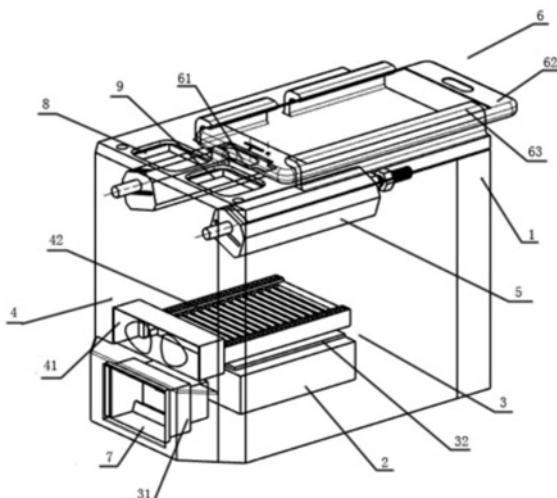
1. 一种检测微囊藻毒素的生物传感器，其特征在于，包括生物传感器壳体(1)，设于生物传感器壳体(1)内部的电源模块(2)、孵育模块(3)、免疫反应模块(4)、荧光激发模块(5)和设于生物传感器壳体(1)顶部的信号采集模块(6)；所述电源模块(2)设于生物传感器壳体(1)底部，分别与孵育模块(3)和荧光激发模块(5)相连接；所述孵育模块(3)设于免疫反应模块(4)的下方；所述荧光激发模块(5)设于生物传感器壳体(1)顶部内侧。
