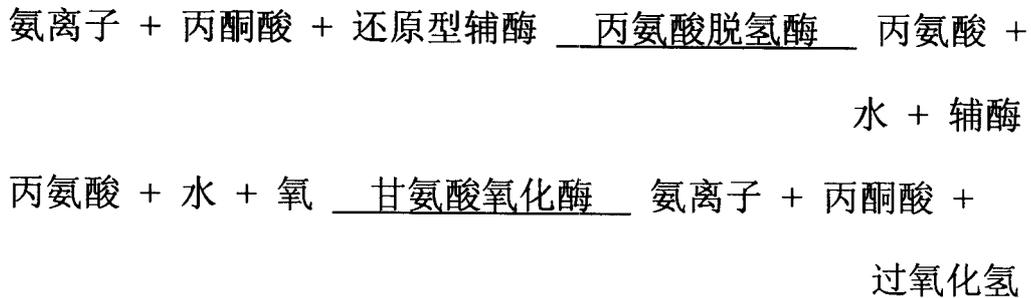
将最终反应物置于紫外/可见光分析仪或半、全自动生化分析仪下，检测主波长 340nm 吸光度下降的速度，测算出氨浓度大小测定结果。
