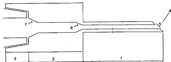
1. 细针组件,用于通过使用细针抽吸(FNA)技术从可疑患处提取细胞样本,其包括管状针构件(1)、限定腔室的存储间(2)以及可以与连接器连接的耦联器(3);
