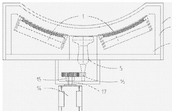
1. 一种带直线移动成像探头的单曲面条状功率超声装置,其特征在于:包括超声聚焦换能器(1)、支撑结构件(4)、水囊(2)和超声成像探头(5),所述超声聚焦换能器(1)通过防水胶水密封在支撑结构件(4)内部的左右两侧,所述支撑结构件(4)的四周设有作为防水全包结构件的水囊(2),所述水囊(2)与支撑结构件(4)之间的空隙填充耦合剂(3),所述支撑结构件(4)的上表面为圆弧状的单曲面,并且支撑结构件(4)中心位置设有方形通孔,在该方形通孔内放置有所述超声成像探头(5),所述超声成像探头(5)与方形通孔的内壁相互贴合并可滑动接触,在超声成像探头(5)的后端端部设有可带动超声成像探头平移的机械传动结构,支撑结构件(4)后部带密封壳结构装载主动齿轮(15)和从动齿条(16),马达(14)传动轴穿过与壳体密切接触的密封圈(17)连接主动齿轮(15)。
