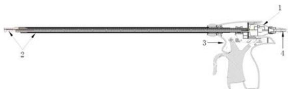
1. 一种具有超声功能的微波手术器械,其特征在于:包括能量合成单元、发射刀头以及手柄;所述发射刀头的后端通过一具有超声波导管功能的同轴内导体与所述能量合成单元连接,所述能量合成单元内部包括一连接器,通过所述连接器,经一外部传输导线与一外部微波发生器和一外部超声波发生器连接;所述能量合成单元可合成输出微波和超声波,所述合成的微波和超声波均可沿所述具有超声波导管功能的同轴内导体传输至所述发射刀头的前端。
