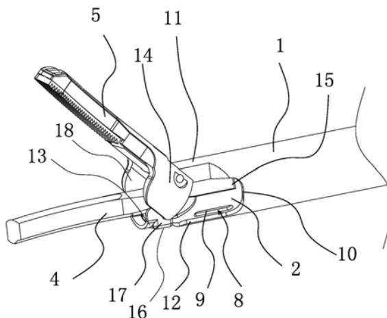
1. 一种导液型超声刀刀头,包括钳杆外管(1),所述的钳杆外管(1)内设有与钳杆外管(1)轴向相对活动连接的内管体(2),所述的内管体(2)内设有波导杆(3),所述的波导杆(3)与钳杆外管(1)轴向相对固定,所述的波导杆(3)的前端延伸出钳杆外管(1)和内管体(2)的前端之外并形成刀杆头(4),所述的内管体(2)前端和钳杆外管(1)前端之间设有钳头(5),所述的钳头(5)与刀杆头(4)相对设置,其特征在于,所述的钳头(5)后端与钳杆外管(1)前端之间相铰接且两者之间的铰接轴线为静铰接轴线(6),所述的钳头(5)后端与内管体(2)前端之间相铰接且两者之间的铰接轴线为动铰接轴线(7),所述的静铰接轴线(6)和动铰接轴线(7)相互平行且分别位于刀杆头(4)的两侧,所述的内管体(2)前端侧部设有连通内管体(2)内侧和外侧的导液结构(8)。
