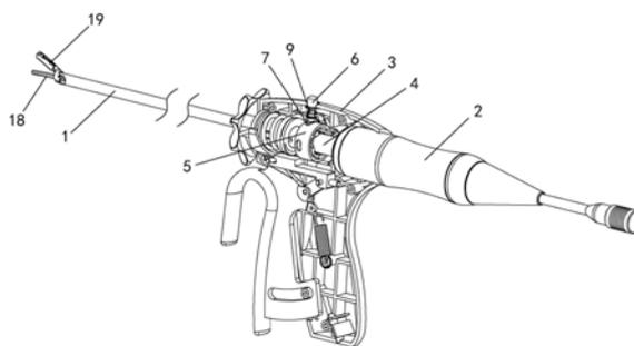
1. 一种新型超声刀,包括刀头和换能器,两者同轴设计,且刀头的后端与换能器的前端均伸入超声刀的壳体内部并螺纹连接固定;其特征在于:还包括固定管、转动环以及锁定按钮;
