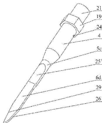
1. 一种用于超声外科手术刀系统的手术刀,其特征在于,由上至下依次包括连接部、止挡部、刀柄、刀臂和刀头,所述刀头的刃部呈线状且上厚下薄,所述手术刀通过所述连接部可拆卸地连接于所述超声外科手术刀系统的超声换能器。
