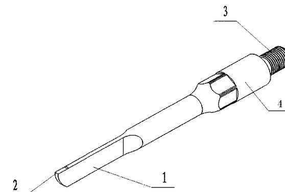
1. 一种楔形刃超声骨刀刀头,其特征在于,包括刀片和刀尖,所述刀尖位于刀片的正前端,刀尖的两边分别与刀片的两边位于同一条直线上,刀尖的一边长于刀尖的另一边。
