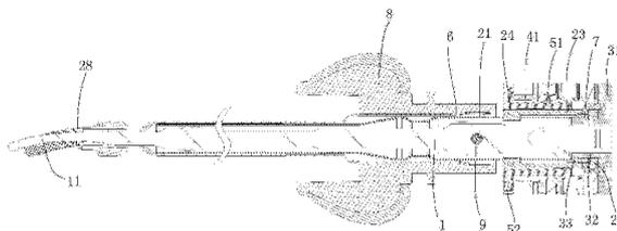
1. 一种超声刀刀杆组件,包括连接有第一半剪头的传力机构以及设有第二半剪头的超声波作用杆,其特征在于:还包括用于接受外部拨动压力并施加于传力机构的传压组件,在所述传压组件与传力机构之间设置有压力检测元件。
