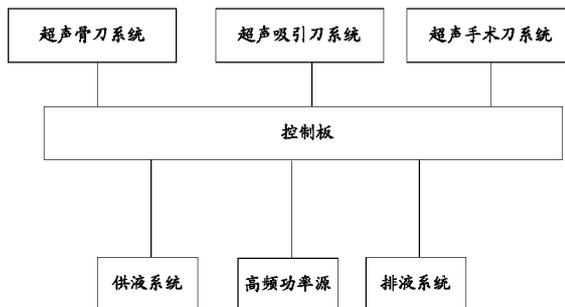
1. 一种超声外科手术刀系统,其特征在于,包括:控制板和高频功率源,分别与所述控制板连接的超声骨刀系统、超声吸引刀系统、超声手术刀系统、供液系统和排液系统,其中,所述控制板用于根据用户的选择将所述超声骨刀系统、超声吸引刀系统、超声手术刀系统之一与所述高频功率源、所述供液系统和所述排液系统连通;所述超声骨刀系统包括第一手柄,其中,所述第一手柄具有与所述高频功率源连接的第一超声换能器、与所述第一超声换能器连接的第一变幅杆,以及安装在所述第一手柄的前端、与所述第一变幅杆连接的可拆卸的第一刀具;所述第一手柄还设置有与所述供液系统连接的第一进水口、与所述排液系统连接的第一出水孔以及第一电缆接口,所述高频功率源经所述第一电缆接口与所述第一超声换能器连接;
