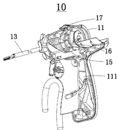
1. 一种超声刀中声波发生器与刀头连接结构,它包括相螺纹连接的声波发生器(20)和工作部(10),所述的声波发生器(20)具有螺纹连接头(21),其特征在于:所述的工作部(10)包括壳体(11)、可旋转地设置在所述壳体(11)内部的中心杆(12)、刀头(13),所述的中心杆(12)的一端与刀头(13)相连接,另一端与声波发生器(20)相螺纹配合连接,所述的壳体(11)内还设有一保护装置,用于在将声波发生器(20)与中心杆(12)相对旋紧的过程中当达到一定力矩时使所述中心杆(12)随螺纹连接头(21)一起转动。
