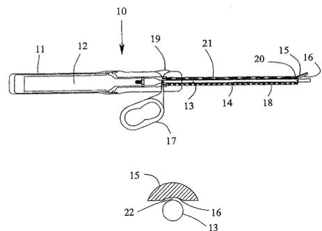
1. 一种用于凝固动物组织的超声波外科手术装置，该装置具有：供外科医生操纵的一手柄，用于产生超声波振动的一超声波转换器，以及附接在超声波转换器上并从手柄延伸以将超声波振动传送至动物组织的一超声波施加器，其中所述装置还包括：
