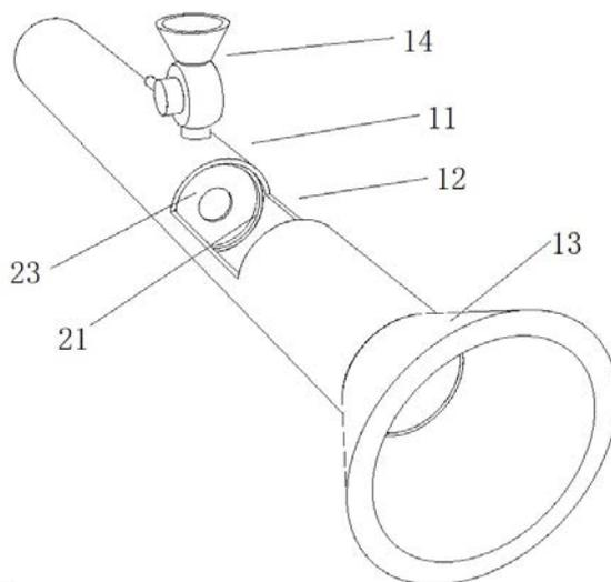
1. 一种有侧孔的腔镜穿刺鞘,其特征是:包括一个管状件,所述管状件包含两端与外界相通的管腔,所述管状件上设有密封件;所述管状件上部的侧壁上至少有一个通孔。
