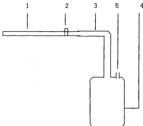
1. 一种腹腔镜吸引器,具有吸引管(1)和储液袋(4),其特征是:吸引管(1)末端设有阀门(2),通过连接管(3)与储液袋(4)连接,储液袋(4)上设有排气阀(5)。
