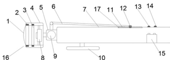
1. 一种口腔内窥镜，包括手柄(7)、连接在手柄(7)上的镜框(4)、连接在镜框(4)内的内窥镜本体(16)，其特征在于：所述镜框(4)与手柄(7)之间连接有旋转机构，所述旋转机构包括连接在手柄(7)上的铰接座(5)，所述镜框(4)上连接有与铰接座(5)配合的铰接轴(9)，所述铰接轴(9)上连接有用于驱动铰接轴(9)旋转的驱动机构。
