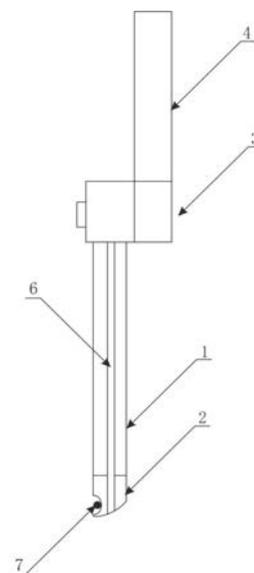
1. 一种脊柱内窥镜微创手术刀,其特征在于,包括通过连接件连接的刀柄和刀体;所述刀体包括与连接件活动连接的刀杆;所述刀杆远离连接件的一端设置有刀头,刀头与刀杆连接处形成刀刃,并在刀头上设置有内窥镜;
