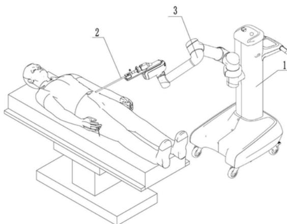
1. 一种腹腔镜手术持镜机器人系统,其特征在于,包括台车机架(1)、手术工具(2)以及设置在所述台车机架(1)上的机械臂(3),所述机械臂(3)的前端设置有具有快卸装置的延长板(4),所述手术工具(2)通过所述快卸装置固定在所述延长板(4)上,其中,所述机械臂(3)具有至少六个自由度。
