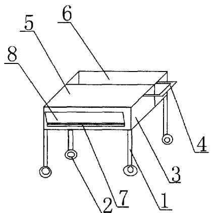
1. 便捷超声诊断装置,包括支腿(1)、滑轮(2)、器械台(3)和推柄(4),其特征是:在器械台(3)前端设有显示台(5),器械台(3)后端设有主机槽(6),器械台(3)前侧下端设有折页(7),折页(7)上设有键盘托(8)。
