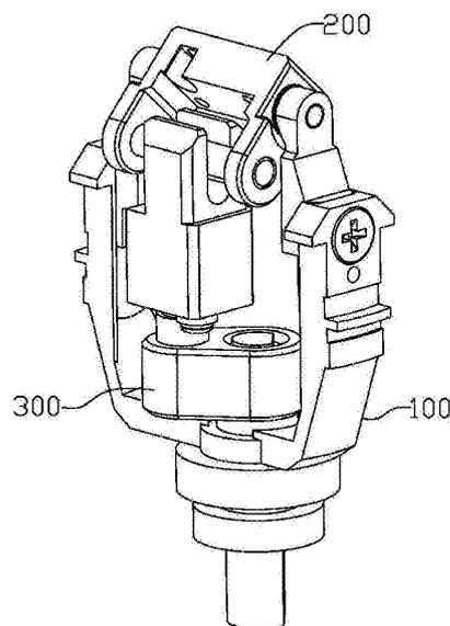
1. 一种传动机构,其特征在于,包括支架、摆动座、连接件、曲轴与驱动件,其中所述驱动件与所述曲轴连接,并可由所述曲轴驱动绕第一轴心转动;所述摆动座与所述支架连接,并可相对所述支架绕与所述第一轴心垂直的第二轴心转动;所述连接件与所述摆动座连接;且随所述驱动件绕所述第一轴心的转动,所述连接件可在相对所述驱动件沿所述第一轴心方向运动的同时,带动所述摆动座绕所述第二轴心摆动。
