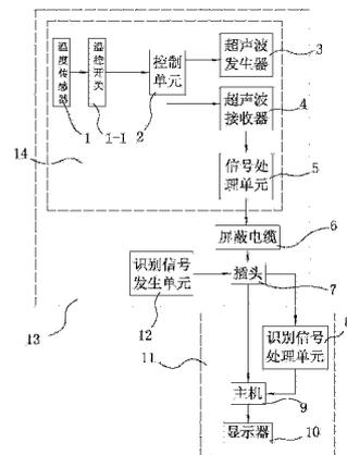
1. 一种温度感应式自动切换探头型 B 超检测系统,包括主机部分(11)和 B 超探头组件(13),主机部分(11)包括主机(9)和连接于主机输出端上的显示器(10),B 超探头组件(13)包括探头(14)、插头(7)以及连接于探头(14)和插头(7)第一输入端之间的屏蔽线缆(6),其特征在于:
