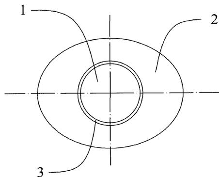
1. 一种医用超声水垫，其特征在于水垫中心设有水囊（1），水囊内装有去汽水，水囊外周设有自粘式贴片（2），水囊与自粘式贴片间设有支撑骨架（3），水囊的上、下两面设有医用超声耦合剂层（4）。
