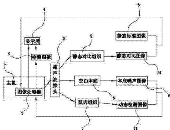
1. 一种基于本底去噪的超声波探头检测系统,包括超声波探头(2)、显示屏(4)及用于控制超声波探头(2)的主机(1),其特征在于:还包括静态对比组织(5)、静态标准图像(8)、空白本底(6)以及装置于主机(1)上的图像处理器(3),所述超声波探头(2)通过检测所述静态对比组织(5)得到静态对比图像(51)、通过检测空白本底(6)得到本底噪声图像(61)以及通过检测肌肉组织(7)得到动态检测图像(71),所述图像处理器(3)将静态对比图像(51)与静态标准图像(8)通过对比处理,图像处理器(3)将动态检测图像(71)与本底噪声图像(61)叠加处理得到检测图像(9)。
