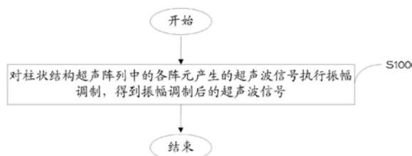
1. 一种超声波信号调整方法,其特征在于,所述超声波信号调整方法基于柱状结构超声阵列,所述超声波信号调整方法包括:
