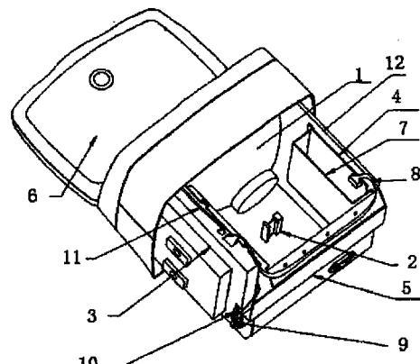
1. 一种便携超声诊断仪,包括主机架、CRT 显像管、CRT 驱动板、电源板、主板与探头板,其特征是 :所述 CRT 显像管、CRT 驱动板安装于所述主机架上 ;所述电源板竖直设置于所述主机架一侧,所述主板与探头板竖直设置于所述主机架另一侧 ;所述主板罩设有主板屏蔽罩 ;所述探头板罩设有探头板屏蔽罩。
