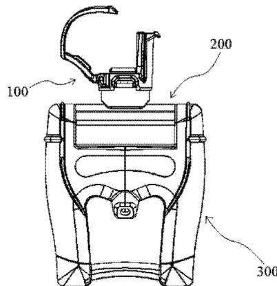
1. 一种手持式扫描辅助设备,其特征在于,包括:“H”字形中空壳体,固定在所述中空壳体上的扫描传动机构,与所述扫描传动机构传动连接的超声探头支架;
