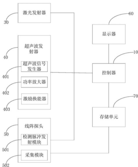
1. 一种用于甲状腺疾病检查的成像系统,其特征在于,包括控制器、激光发射器、超声波发射器、线阵探头与显示器;
