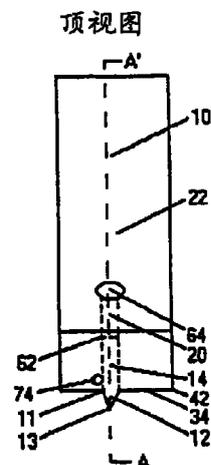
1. 一种流体采样装置，该装置包括一本体，该本体包括一具有透刺端及连通端的表皮层透刺探头，以及一具有近端及远端的分析室，该分析室具有一容积，其中所述分析室包括一电化学单元，该单元包括一工作电极和一反电极/参考电极，所述采样装置还包括一前置室，该前置室具有一容积和一第一端及第二端，其中该前置室布置在透刺探头和分析室之间，使得前置室的第一端靠近透刺探头的连通端，而前置室的第二端靠近分析室的近端，其中前置室的容积大于或等于分析室的容积，其中该透刺探头与该分析室流体连通，使得流体可以从透刺探头向分析室流动。
