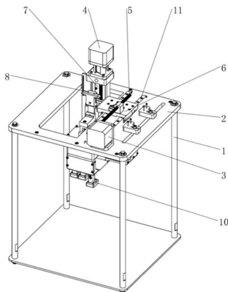
1. 一种脉诊仪,包括机架、工作台、电机、压力传感器,其特征在于:机架(1)上设有工作台(2),工作台(2)上设有平移电机(3),平移电机(3)的伸出轴连接滚珠丝杠(5),所述的滚珠丝杠(5)通过滚珠螺母连接滑板(6)的上部,滑板(6)的一侧连接电机连接板(7),电机连接板(7)的上端固定连接升降电机(4),升降电机(4)的伸出轴连接另一滚珠丝杠(8),所述的另一滚珠丝杠(8)通过滚珠螺母连接滑块(9),滑块(9)的顶部采用压力传感器连接件(13)连接压力传感器(10)。
