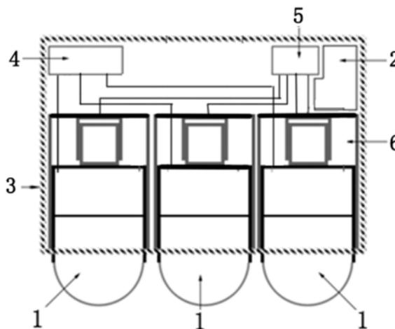
1. 一种基于高清高速摄像技术的脉象获取设备,其特征在于,包括三个脉象传感器,分别用于获取尺脉、关脉和寸脉的脉象信息;
