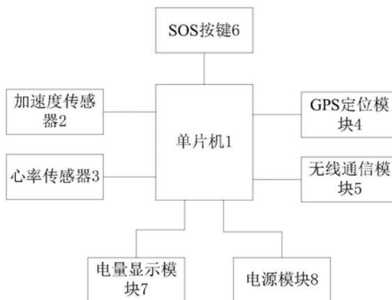
1. 一种具有人体健康预测的智能穿戴设备,其特征在于,包括外壳,所述外壳处设有一个佩戴手环,所述外壳内设有电路板,所述电路板上设有单片机、加速度传感器、心率传感器、GPS定位模块、无线通信模块、SOS按键、电量显示模块和电源模块,所述加速度传感器、心率传感器、GPS定位模块、无线通信模块、SOS按键、电量显示模块和电源模块均与所述单片机连接;
