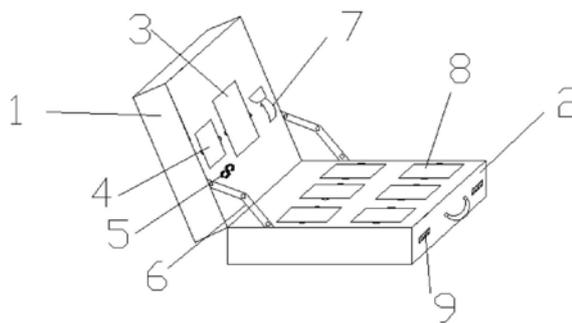
1. 多功能慢性病诊断装置,其特征在于:包括诊断设备和箱体,所述诊断设备包括健康管理终端(3)、身份识别装置(4)、检测设备,所述箱体包括上半箱体(1)和上半箱体(1)下方设置的下半箱体(2),所述上半箱体(1)和下半箱体(2)上设置多个储物槽(8),所述储物槽(8)内放置健康管理终端(3)、身份识别装置(4)、检测设备,所述身份识别装置(4)通过连接线(5)连接健康管理终端(3),所述健康管理终端(3)内部安装蓝牙模块,所述检测设备包括体温检测器(7),所述体温检测器(7)内部安装蓝牙模块,体温检测器(7)通过蓝牙模块与健康管理终端(3)进行数据传输。
