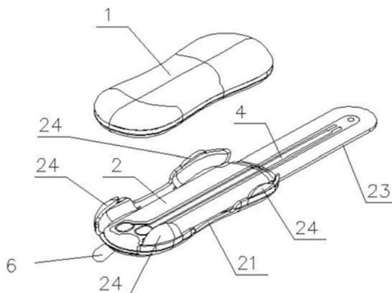
1. 一种分体式穿戴体温计,其特征在于:包括体温计主机(1)和体温贴片(2),所述体温计主机(1)包括外壳(11)以及位于外壳外的导电部件(12),所述导电部件(12)与主机(1)内主控板电连接;
