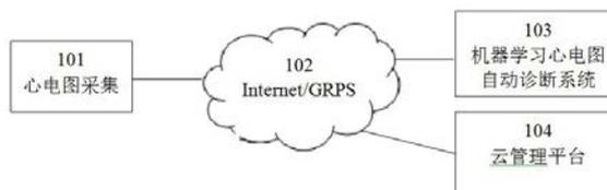
1. 机器学习心电图自动诊断系统,其特征在于,所述的系统包括:心电图采集,互联网/移动互联网,云平台及机器学习心电图自动诊断系统。
