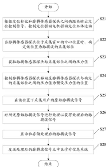
1. 一种中医脉诊仪,该中医脉诊仪包括处理器、存储器以及显示器,其特征在于,所述中医脉诊仪还包括定位单元、传感器单元以及通信单元,所述中医脉诊仪通过通信网络与中医诊疗信息系统通信连接,所述存储器、显示器、定位单元、传感器单元以及通信单元均与所述处理器电连接,所述定位单元包括定位驱动电机以及定位本体,所述定位本体上设置有定位窗口,所述定位窗口周围设置有用对准脉搏位置的定位标记,所述传感器单元包括脉搏传感器探头和采集窗口,所述采集窗口设置于所述传感器单元的底部,所述脉搏传感器探头穿过所述采集窗口,所述脉搏传感器探头上设置有压力传感器,所述压力传感器与所述处理器电连接,其中:
