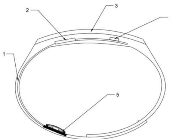
1. 一种用于运动时测量心率的智能手环装置,其特征在于:包括环形骨架、心率测量系统和脉搏传感器,所述心率测量系统包括蓝牙处理传输模块、电源模块和显示模块;所述心率测量系统的蓝牙处理传输模块和电源模块安装在环形骨架的上部,显示模块安装在环形骨架顶部的凸台上;所述脉搏传感器安装在手环骨架下部的环内侧;
