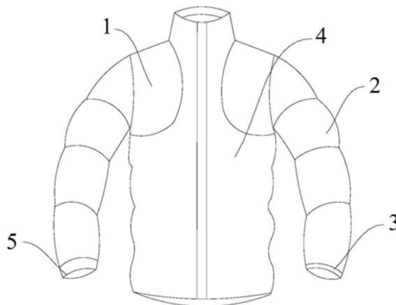
1. 一种具有紧急报警功能的羽绒服,包括羽绒服主体,该羽绒服主体内设置有身体检测机构、保温机构、运动防护机构和警报机构,其特征在于:所述身体检测机构包括可拆卸式设置于该羽绒服胸部外表面的心率检测仪(1),所述心率检测仪(1)与设置于该羽绒服表面的控制器的输出端连接;
