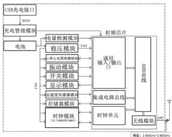
1. 一种智能心率心电手环,其特征在于,所述手环包括手环壳体以及设于所述手环壳体内部的主电路,所述主电路包括射频芯片,以及与所述射频芯片连接的电量检测模块、稳压模块、用于测试心率及心电图的心率心电图检测模块、用于显示心率及心电图的显示模块、用于存储数据的存储模块、用于开启手环的开关模块、用于提供时钟信号的时钟模块和用于提示的振动模块;
