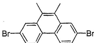
30 43.4 g (113 mmol) 2,7-Dibrom-9-hydroxy-10,10-dimethyl-9,10-dihydrophenanthren wurden in 610 mL Essigsäure suspendiert. Es wurden 780 mg Iod und 3.5 mL HBr in Essigsäure zugegeben und die Suspension zum Rückfluss erhitzt. Über Nacht ließ man unter Rühren abkühlen. Der Rückstand wurde abgesaugt und mit Wasser und Methanol gewaschen. Man erhielt 35.8 g (87.0 % d. Th.) des Produkts.
