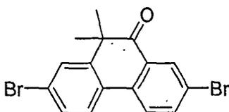
132.8 g (294 mmol) 2,7-Dibrom-9,10-dihydroxy-9,10-dimethyl-9,10-dihydrophenanthren wurden unter Argon in 420 mL Essigsäure und 210 mL Trifluoressigsäure suspendiert und 3 h unter Rückfluss gerührt. Nach Rühren über Nacht bei Raumtemperatur wurde abgesaugt, der Rückstand mit Wasser und Methanol gewaschen, in Toluol gelöst, über Kieselgel filtriert und das Lösemittel entfernt. Man erhielt 89.9 g (80.4 % d. Th.) des Produkts, das ohne weitere Aufreinigung verwendet wurde.
