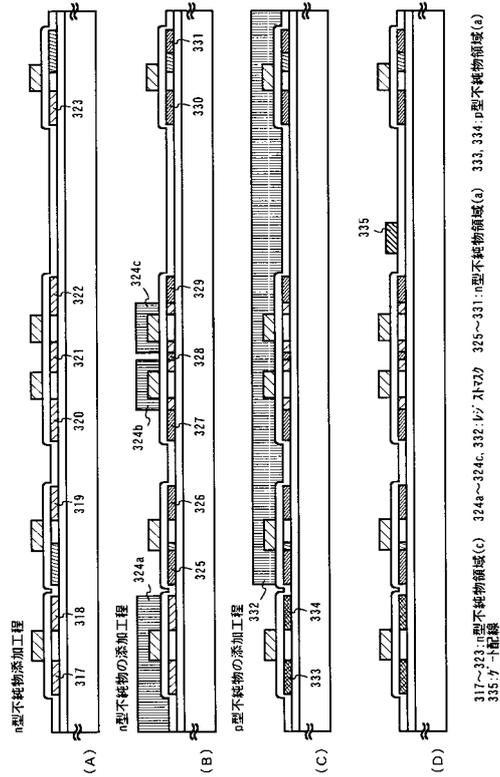
317~323: n型不純物領域 (c) 324a~324c, 332:  $\text{Si}_3\text{N}_4$  膜 325~331: n型不純物領域 (a) 333, 334: p型不純物領域 (a)
