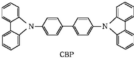
【0017】に示すキャリア輸送材料と燐光発光性材料である。
