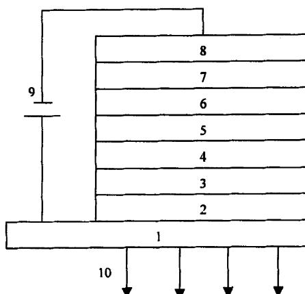
1、用于全色有机发光显示的蓝光器件，包括：衬底(1)、透明导电膜(2)、空穴注入层(3)、空穴传输层(4)、发光层(5)、空穴阻挡-电子传输层(6)、电子注入层(7)、阴极(8)、外电路(9)，其特征在于：在有 TBP 材料作为基质材料的空穴传输层(4)上沉积有 TBP 材料作为基质材料和 2, 5, 8, 11-tetra-t-butylperylene 作为掺杂剂的发光层(5)，在发光层(5)的上面沉积有 2, 2', 2''-(1, 3, 5-benzenetriyl)-tris[1-phenyl-1-H-benzimidazole]的空穴阻挡-电子传输层(6)。
