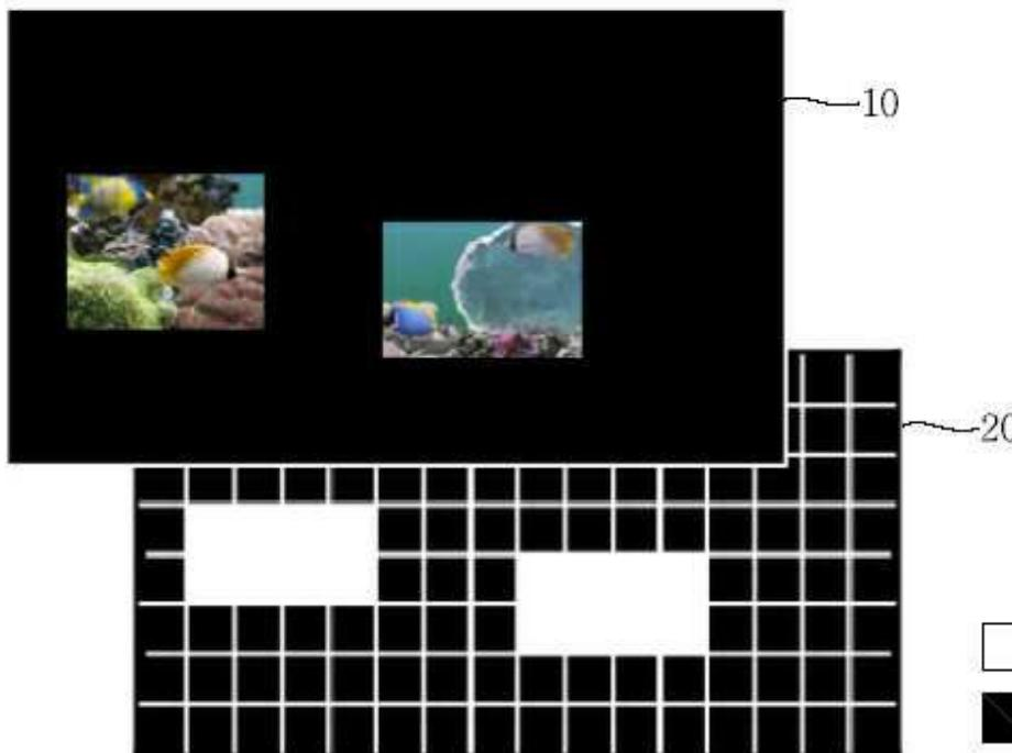
광을 조사하는 백 라이트 유닛; 외부로부터 인테리어모드 선택신호 입력시, 입력 디지털 비디오 데이터와 타이밍 신호를 참조하여 상기 액정표시패널에서의 영역별 표시영상의 움직임 판정신호를 검출하는 영상처리회로; 상기 영역별 표시영상의 움직임 판정신호에 기반하여 동영상 표시영역에 대응되는 광원블럭들과 정지영상 표시영역에 대응되는 광원블럭들을 서로 다르게 구동시키는 것을 지시하는 광원구동 제어신호를 발생하는 백 라이트 제어부; 및 상기 광원구동 제어신호에 응답하여 상기 광원블럭들을 독립적으로 구동하는 다수의 광원구동부들을 포함하며, 상기 광원구동부들의 구동에 의해 상기 동영상 표시영역에 대응되는 광원블럭들은 점등시키는 반면, 상기 정지영상 표시영역에 대응되는 광원블럭들은 소등시키는 백 라이트 구동회로를 구비한다.
