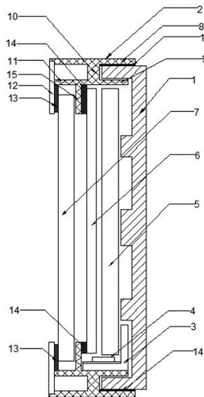
1. 一种新型防水显示模组,其特征在于:包括背板、面框、光学膜片、扩散板、散热片和液晶面板,所述面框包括侧框、支撑部和分隔片,所述分隔片将支撑部分隔为第一支撑部和第二支撑部,所述支撑部与侧框之间设有连接部,所述面框上设有卡槽,装饰面板通过卡槽与侧框连接,所述光学膜片和扩散板设置在背板与分隔片之间的空间内,所述液晶面板设置在装饰面板与分隔片之间的空间内,所述背板分为垂直部分和水平部分,垂直部分设置在侧框与第二支撑部之间,所述装饰面板和液晶面板之间设置密封光学胶,所述侧框与背板连接缝处、分隔片与扩散板连接缝处均设有密封条。
