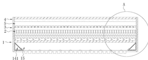
1. LCD显示器,包括背光模组,其特征在于:所述背光模组包括依次设置的散热件、LED灯组、反射层、扩散层、下增光层和上增光层;所述散热件上套设有散热框体;所述LED灯组的灯珠穿过所述反射层;所述扩散层、所述散热框体、所述反射层围合形成光源空间;所述扩散层面向所述LED灯组的一侧设有隔热透光层。
