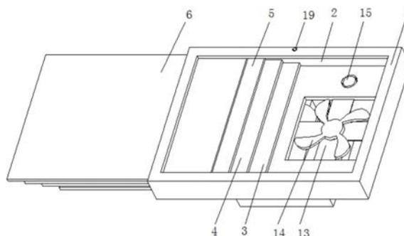
1. 一种LED背光源液晶显示装置,包括安装框(1),其特征在于:所述安装框(1)内设有安装槽(2),所述安装槽(2)内滑动连接有安装板(3),所述安装板(3)上设有散热孔(18),所述安装板(3)的表面设有光源组(4),所述光源组(4)的表面设有背光源背板(5),所述背光源背板(5)的表面设有显示屏(6),所述安装框(1)的背面设有PLC控制器(12),所述PLC控制器(12)的输出端电连接光源组(4)和显示屏(6)的输入端。
