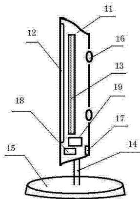
1. 一种带散热装置的 LCD 显示屏,其特征在于,包括由显示屏本体所形成的一容置空间,该容置空间内设置有背光源模组,所述容置空间底部设置有集成模块;所述集成模块连接有散热装置,所述散热装置包括铝基板和固定于铝基板的铝制散热片;所述铝制散热片包括多个散热翅片,所述散热翅片表面设有镀镍层,所述散热翅片与铝基板之间设有锡层,所述散热翅片与铝基板通过锡层焊接在一起;所述显示屏本体下设支撑架,支撑架与底座固定。
