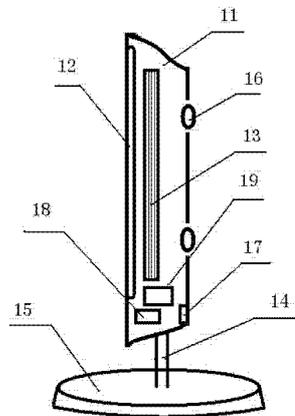
1. 一种带过压保护装置的 LCD 显示屏,其特征在于,包括由显示屏本体所形成的一容置空间,该容置空间内设置有背光源模组,所述容置空间底部设置有集成模块;所述集成模块连接有过压保护装置,所述过压保护装置包括检测控制装置和开关装置,其中开关装置串联在市电与被保护电器之间;其中检测控制装置包括集成电阻、二极管和一个三极管;所述集成电阻和反向偏置的二极管依次连接在三极管的基极与发射极之间;所述显示屏本体下设支撑架,支撑架与底座固定。
